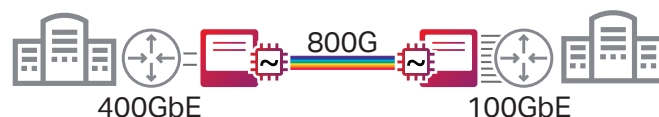
図1: シングルスパンDCIアプリケーションに使用されているWaveLogic 5 Extreme
