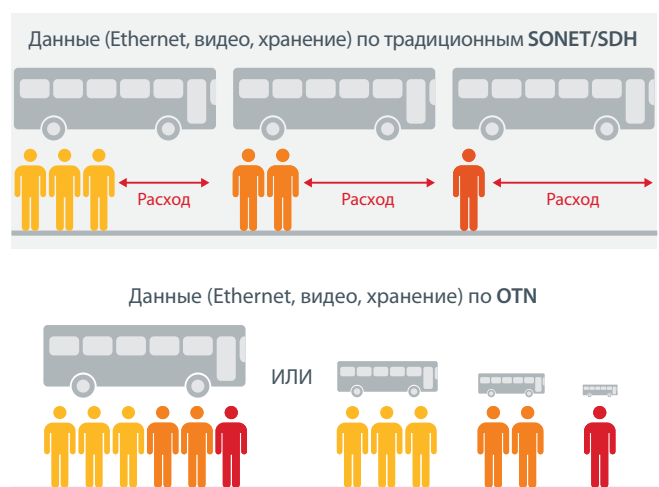
Рисунок 4. Программируемость OTN позволяет использовать полосу пропускания более эффективно
